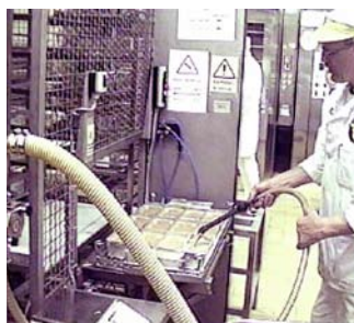
Maskinen startar automatiskt efter inställd paustid mellan formarna.
